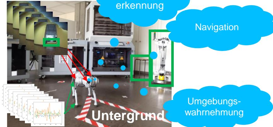
8 Zeitreihensignale (Fußdrucksensoren & IMU)
